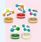
Gases Sensores electroquímicos detectan monóxido de carbono (CO), dióxido de nitrógeno (NO2), dióxido de azufre (SO2), ozono (O3) y sulfuro de hidrógeno (H2S).
